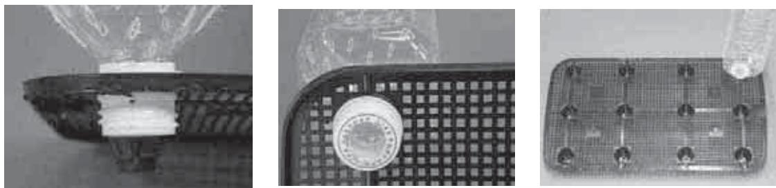
図23 給水筒となるペットボトルのとりつけ
